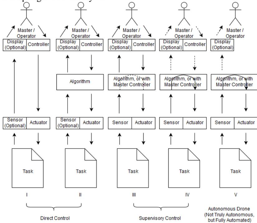
FIGURE 1. SCALING DRONE AUTONOMY<sup>280</sup>
